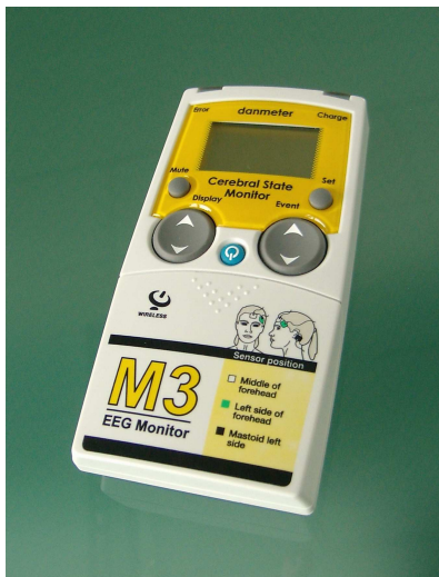
CSM M3™ Aufnahmegerät am Patienten, funkt Parameter zu Überwachungsmonitor
